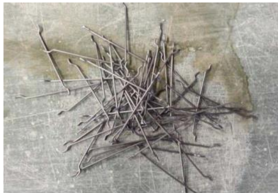
Рис. 1. Сталеві волокна з гачкоподібними кінцями (анкерна фібра) [1]
