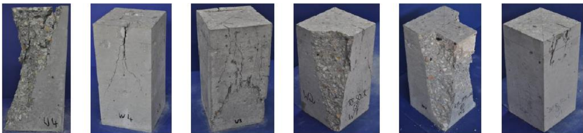
Рис. 4. Приклади руйнування бетонних і СФБ-призм за умов дії центрального навантаження та з ексцентриситетом [10]
